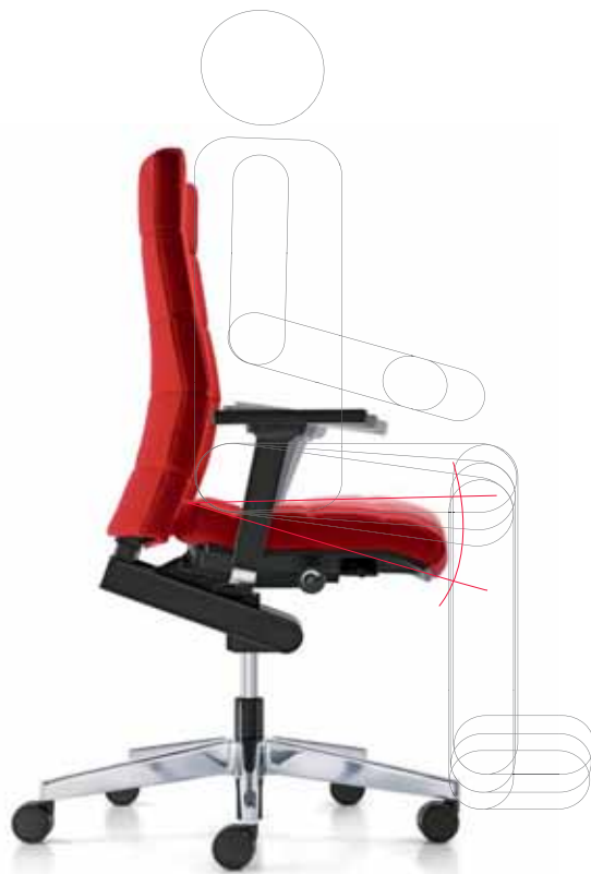
Die freitragende Sitzvorderkante ermöglicht eine komfortablere Sitzneigeverstellung. Durch die neuartige Aufhängung an der hinteren Sitzfläche muss die Sitzhöhe, wie auch die Höhe der Lordosenstütze bei veränderter Neigung nicht mehr nachjustiert werden.
